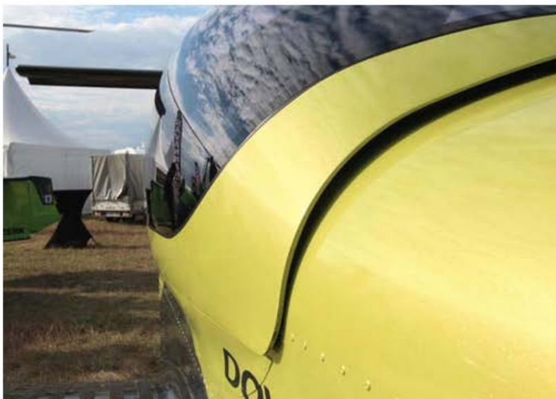
Nouvelle verrière élargie pour une largeur de 1,18 m aux épaules.
