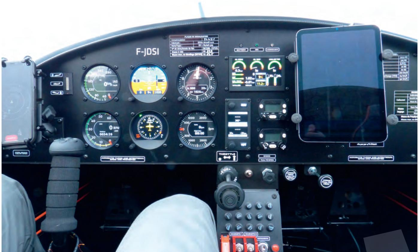
*L'instrumentation est signée Kanardia. Elle comporte un badin, un altimètre, un compte-tours, un variomètre, et un mini-EFIS en double exemplaire (ici, l'un affiche l'horizon artificiel, l'autre le compas). Sur la droite, un EMS concentre tous les paramètres moteur.*
